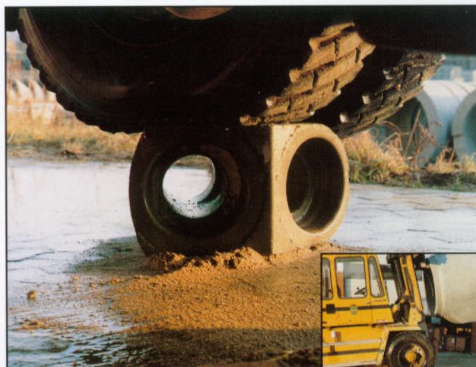
Grenrør er overordentlig stærke. Hjultrykket fra denne 15 tons containertruck, lastet med et fem tons betonrør, kan sagtens optages i grenrøret. Laboratorieforsøg viser en brudstyrke på over 21 tons.
