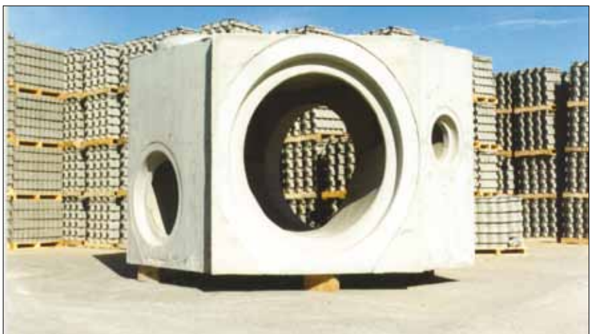
Store brønde med vægt op til 40 tons vådstøbes. De fremstilles efter tegning.
