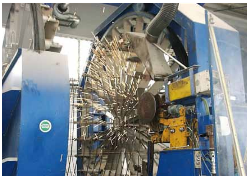
Armeringsnet fremstillet på armeringsmaskine. Armeringen er leveret af certificeret producent og er i henhold til gældende armeringsstandarder.
