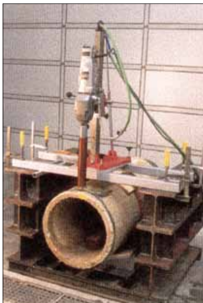
Foto fra en af de mange betonteknologiske undersøgelser af de forskellige indsamlede ældre betonrør.
