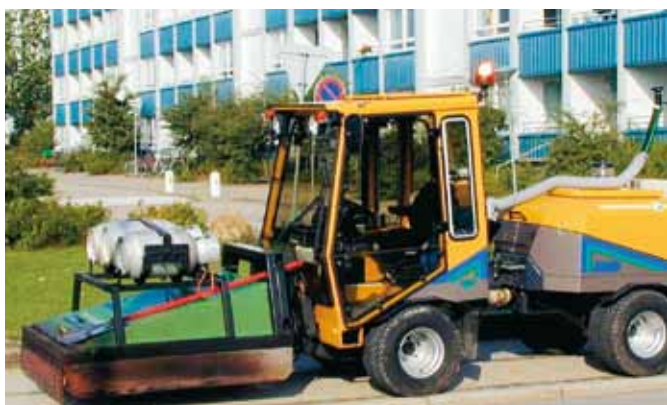
Pesticidfribekæmpelse af ukrudt med maskinmonteret ukrudtsbrænder.
